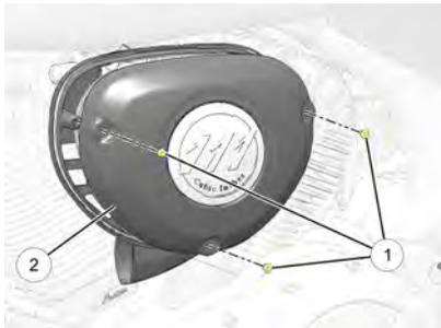
2. Extraiga los tres tornillos del filtro de aire ③ y extraiga el conjunto del filtro de aire.
